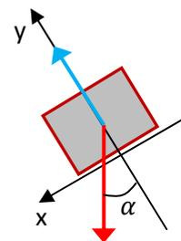
A segunda lei de Newton diz que  $\vec{R} = M \vec{a}$ . Ao longo de x obtemos:  $P \sin(\alpha) = M a \Rightarrow M g \sin(\alpha) = M a$ . Portanto, concluímos que o bloco desce com aceleração de módulo  $a = g \sin(\alpha)$ . A aceleração não depende da massa do bloco. Se a superfície fosse horizontal, não haveria aceleração, pois  $a = g \sin(\alpha = 0) = 0$ .
