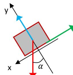
A primeira lei de Newton diz que  $\vec{R} = \vec{0}$ . Ao longo de x obtemos:  $-F_A^{(E)} + P \text{sen}(\alpha) = 0 \Rightarrow F_A^{(E)} = M g \text{sen}(\alpha)$ . Essa é a força de atrito que “trava” o bloco e não deixa ele descer. Ao longo de y obtemos:  $\eta - M g \text{cos}(\alpha) = 0 \Rightarrow \eta = M g \text{cos}(\alpha)$ .
