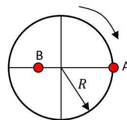
a) Qualquer ponto dessa roda (fora do eixo de rotação) descreve uma trajetória circular com um raio de giração (distância ao eixo de rotação)  $0 < r \leq R$ . Para o ponto A vale  $r = R$  e para o ponto B vale  $r = R/2$ . A velocidade de rotação  $\omega$  (velocidade angular) é a mesma para todos os pontos da roda (todos os pontos dão a mesma quantidade de voltas no mesmo tempo):  $\omega_A = \omega_B = \omega_{RODA}$ .
