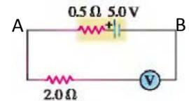
Um voltímetro ideal possui resistência elétrica interna infinita e, por isso, não circula corrente elétrica por ele. Ele se comporta como um circuito aberto. Portanto, fica claro que o circuito mostrado na Figura está aberto (pelo voltímetro ideal) e não circula corrente por ele.
