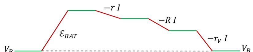
O resultado que obtivemos para  $I$  é o esperado, posto que os três resistores estão em série. Essa seria a corrente no circuito se o voltímetro fosse não-ideal. Tomando agora o limite  $r_V \rightarrow \infty$  (voltímetro ideal) obtemos:
