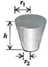
Podemos pensar o resistor cônico como sendo uma sucessão (uma pilha) de resistores cilíndricos de raios diferentes, um colado no outro, em uma associação em série.
