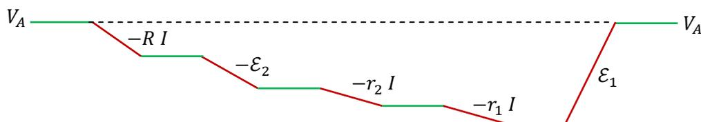
Os platôs (em verde) correspondem aos condutores perfeitos (fios ideais de resistência nula = equipotenciais) que conectam os resistores e baterias no circuito.
