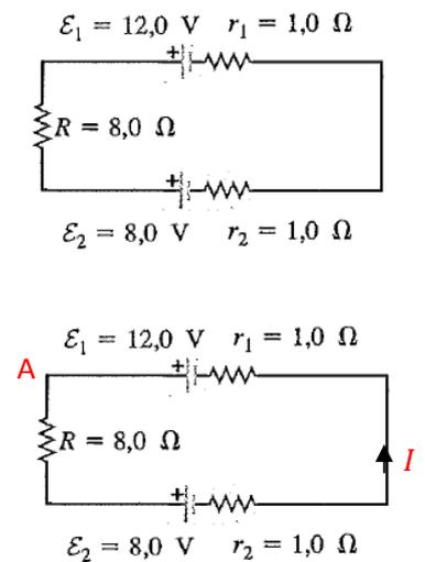
Partimos do ponto A, onde o potencial vale  $V_A$  e vamos atravessando os dispositivos e seus “degraus de potencial” correspondentes. Todos os resistores são atravessados no mesmo sentido da corrente e, por isso, são degraus de descida. A bateria de FEM  $\mathcal{E}_2$  é atravessada do + para o - e também é um degrau de descida. Apenas a bateria de FEM  $\mathcal{E}_1$  é um degrau de subida.
