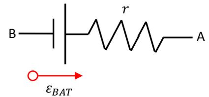
Suponha que uma corrente  $I_{\rightarrow}$  circule de B para A por dentro da bateria (e de A para B através do circuito externo). Então, integrando o campo elétrico de B para A obtemos:
