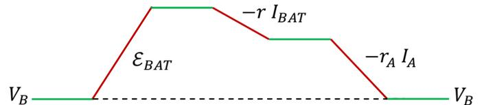
Seja  $I$  a corrente através do resistor  $R$  (de A para B). Percorrendo a malha que contém a bateria e esse resistor, partindo de B, obtemos:
