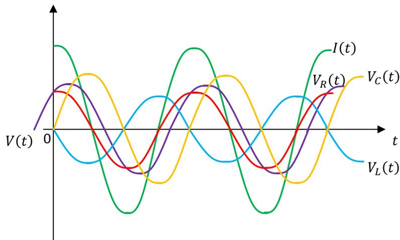
$V(t)$  está atrasada em relação à  $I(t)$ , pois trata-se de um circuito predominantemente capacitivo. Note que em  $t=0$   $I(t)$  está no máximo, mas o máximo de  $V(t)$  vai ocorrer um pouco depois. Por isso  $V$  está atrasada.
