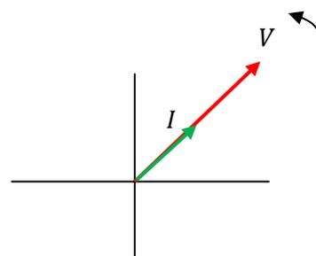
Um resistor é apenas um arraste e os portadores de carga se movem de acordo com a “vontade” da fonte de voltagem.
