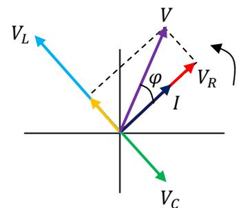
Nesse diagrama estamos assumindo, para ilustrar, que  $V_{0L} > V_{0C}$  (por isso o fasor azul é maior que o verde), ou seja,  $X_L > X_C$ , já que:  $V_{0L} = X_L I_0$  e  $V_{0C} = X_C I_0$ . Nesse caso o ângulo  $\varphi$  é positivo, ou seja, a voltagem na fonte está mesmo adiantada em relação à corrente. O circuito é predominantemente indutivo.
