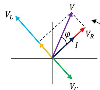
diagrama fasorial, lembrando que há apenas uma corrente (circuito série), que a voltagem em R ( $V_R$ ) está em fase com a corrente, que a voltagem no capacitor ( $V_C$ ) está atrasada em relação à corrente de  $\pi/2$  rad e que a voltagem no indutor ( $V_L$ ) está adiantada em relação à corrente de  $\pi/2$  rad. Portanto, o diagrama fica como mostrado acima (o fasor amarelo é a soma  $V_L + V_C$ ).
