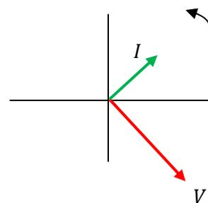
Os portadores de carga se movem à mercê da competição entre a fonte de voltagem e a carga/descarga em C.
