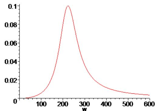
sistema apresenta um máximo em uma determinada frequência especial. No caso do circuito RLC série as respostas do sistema (à excitação oscilatória da fonte de voltagem) que apresentam esse máximo são a corrente, o fator de potência e a potência média dissipada no resistor, conforme podemos ver aqui.
