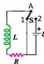
Primeiramente ele se opõe ao crescimento da corrente e depois ele se opõe ao decaimento da corrente. Se deixarmos a chave parada na posição 2 (circuito alimentado pela bateria) a
