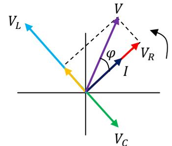
**E/P31.20:** Um circuito RLC série, como no exercício anterior. A voltagem na fonte CA é dada por  $V(t) = V_0 \cos(\omega t + \varphi)$  e a corrente no circuito é:
