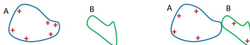
Figura 3: No equilíbrio eletrostático de dois condutores em contato elétrico, o condutor maior fica com uma fração maior da carga elétrica em excesso.
