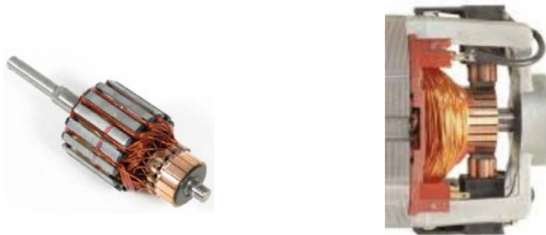
Figura 13: um rotor de um motor elétrico CC. Podemos ver os contatos do comutador, conectados aos terminais das espiras do rotor. A corrente elétrica vem pelo circuito externo, passa por dois contatos de grafite (escovas) que deslizam nos contatos do comutador e conduzem corrente para as espiras do rotor.
