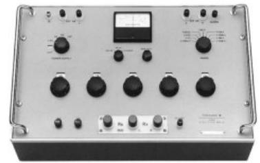
Se quisermos fabricar um resistor com um dado valor preciso de resistência, colocamos esse valor de resistência almejado nos botões, conectamos um resistor à ponte e vamos modificando ele até que a corrente se anule. Infelizmente trata-se de um aparelho caro. Encontramos um anúncio na internet\* por “apenas” 11.000 dólares. Aparelhos de medição elétrica precisos são caros.
