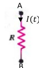
Um resistor é um dispositivo que obedece à lei de Ohm. Portanto, é fácil ver na Figura ao lado que, sendo  $\vec{j} = \sigma \vec{E}_q$ , segue que se a corrente flui de A para B então o campo  $\vec{E}_q$  dentro do resistor aponta de A para B, ou seja  $V_A > V_B$ .
