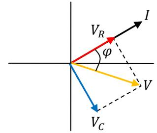
com  $V_0$  a amplitude da voltagem na fonte (tamanho do fasor laranja) e  $X_C = 1/\omega C$
