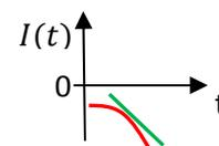
Quando  $I(t)$  flui de B para A ( $I < 0$ ) e está decrescendo em magnitude ( $dI/dt > 0$ ), o campo elétrico  $\vec{E}_I$  se opõe a esse decaimento, apontando de B para A. Portanto,  $\vec{E}_q$  aponta de A para B, o que implica que  $V_A > V_B$  ( $V_{AB} > 0$ ), de acordo com a equação  $V_{AB}(t) = L dI(t)/dt$ . Note que quando uma função negativa diminui em módulo ela tem derivada positiva, conforme a Figura ao lado para a curva  $I(t) \times t$ .
