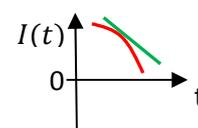
Quando  $I(t)$  flui de B para A ( $I < 0$ ) e está crescendo em módulo ( $dI/dt < 0$ ), o campo elétrico  $\vec{E}_I$  se opõe a esse crescimento, apontando de A para B. Portanto,  $\vec{E}_q$  aponta de B para A, o que implica que  $V_A < V_B$  ( $V_{AB} < 0$ ), de acordo com a equação  $V_{AB}(t) = L dI(t)/dt$ . Note que quando uma função negativa cresce em módulo ela tem derivada negativa, conforme a Figura ao lado para a curva  $I(t) \times t$ .
