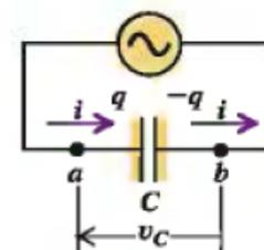
vale sempre.  $i(t)$  é a corrente mostrada na Figura, com o sentido positivo indicado pela seta (sentido anti-horário). Quando a corrente for negativa, significa que ela inverteu de sentido (sentido horário). Ao mesmo tempo,  $q(t)$  é a carga na placa esquerda do capacitor, que pode ser positiva ou negativa
